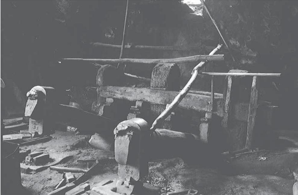
*La batteria di magli a testa d'asino settecentesca per la produzione di attrezzi agricoli in ferro azionata dal motore idraulico mostrato nella fotografia della pagina a fronte.*
