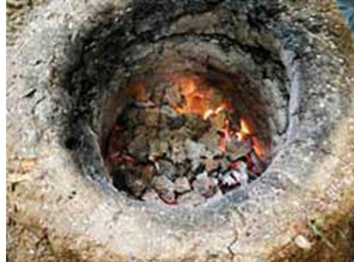
*Ricostruzione sperimentale di un basso fuoco a pozzetto con camino ripreso durante il funzionamento.*
