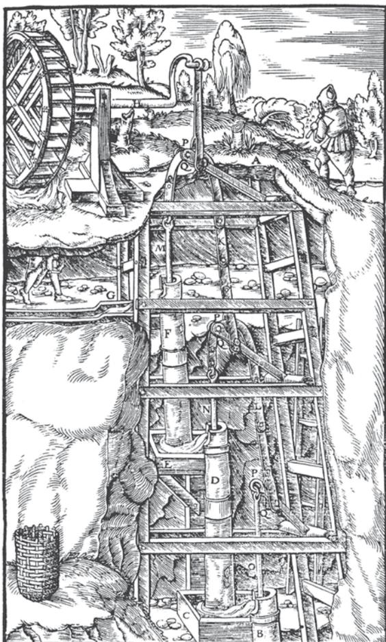
*Pompa a stantuffi azionata da una ruota idraulica dal De Re Metallica.*
